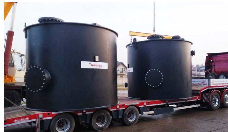
Zbiorniki technologiczne dla węzłów obiegów cieczowych
